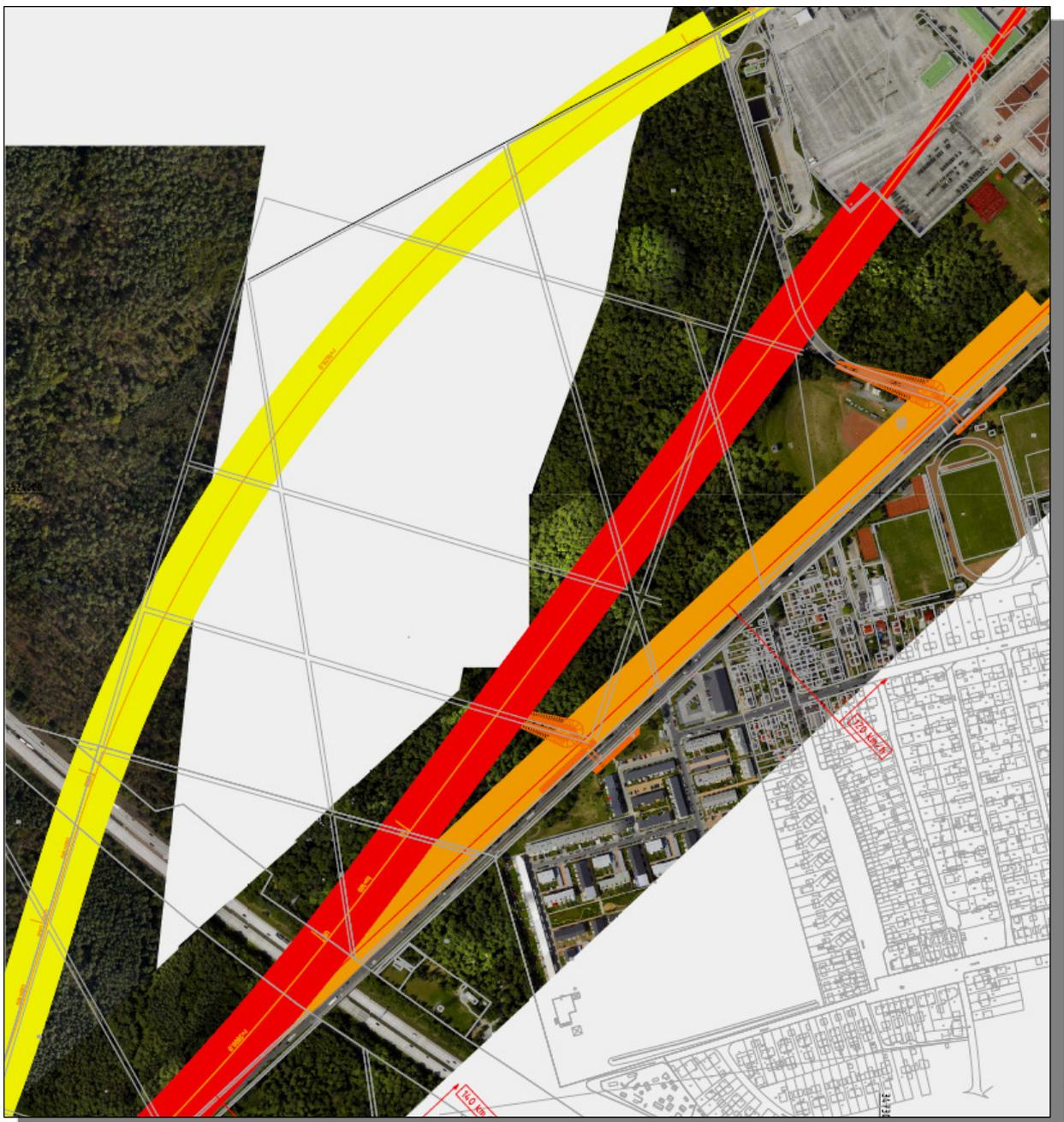
Durch die Bündelung mit der Eschollbrücker Straße weist die Bahn-1-Variante den geringsten Waldflächenrodungsbedarf von 95.000 m<sup>2</sup> auf. Der Behördenentwurf benötigt 120.000 m<sup>2</sup>. Die Reitschneisenvariante kann aufgrund der erforderlichen Kurven kaum mit den vorhandenen Waldwegen gebündelt werden und hat im Wald die größte Streckenlänge aller Varianten. Sie weist daher den größten Waldflächenrodungsbedarf in Höhe von 140.000 m<sup>2</sup> auf.
