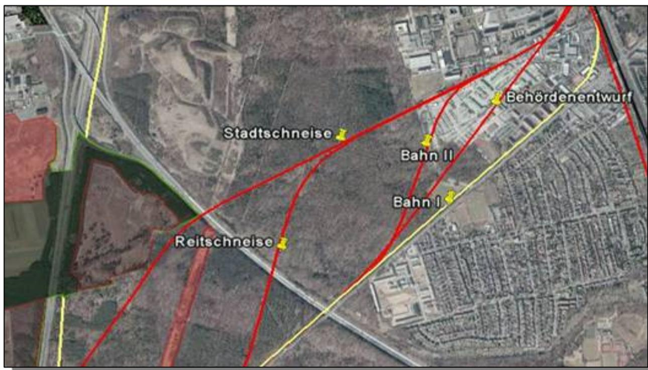
Alle Varianten werden vom Darmstädter Hauptbahnhof kommend zunächst parallel zur bestehenden Main-Neckar-Bahn Richtung Süden geführt.
