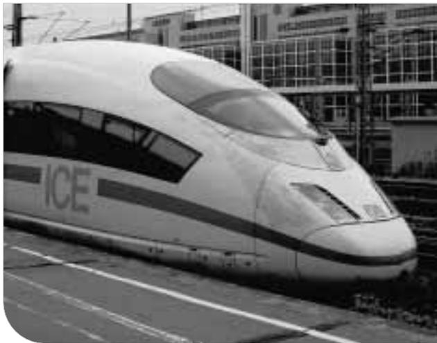
*Die Ausschreibung verlangt eine sehr hohe Anzahl von Sitzplätzen, die nur in Doppelstockwagen oder in Triebwagen untergebracht werden kann. Im ICE-3 ist der gesamte Antrieb in den Reisezugwagen verteilt.*
