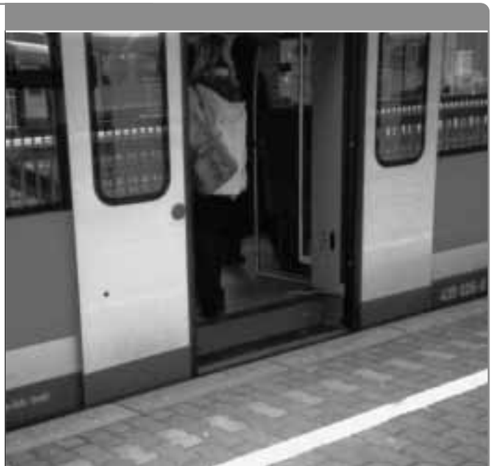
Eine klaffende Lücke zum 76-cm-Bahnsteig (unten) bietet die erste Serie der Elektrotriebwagen der Baureihe 425/426 mit einer im Fahrzeug fest eingebauten Stufe. Mit ihr sollen die 55-cm-Bahnsteige (oben) erreichbar werden. Hier wurde an der falschen Stelle gespart.
