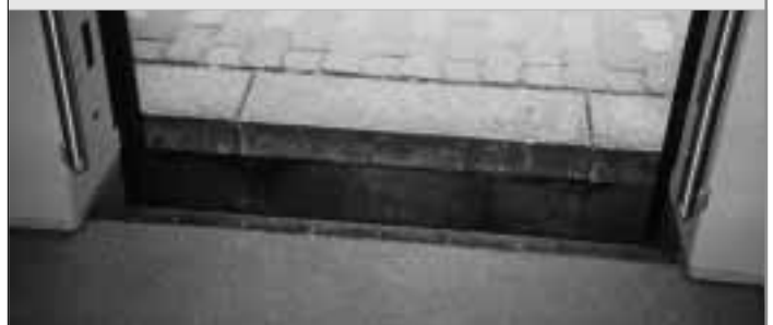
Eine klaffende Lücke zum 76-cm-Bahnsteig (unten) bietet die erste Serie der Elektrotriebwagen der Baureihe 425/426 mit einer im Fahrzeug fest eingebauten Stufe. Mit ihr sollen die 55-cm-Bahnsteige (oben) erreichbar werden. Hier wurde an der falschen Stelle gespart.
