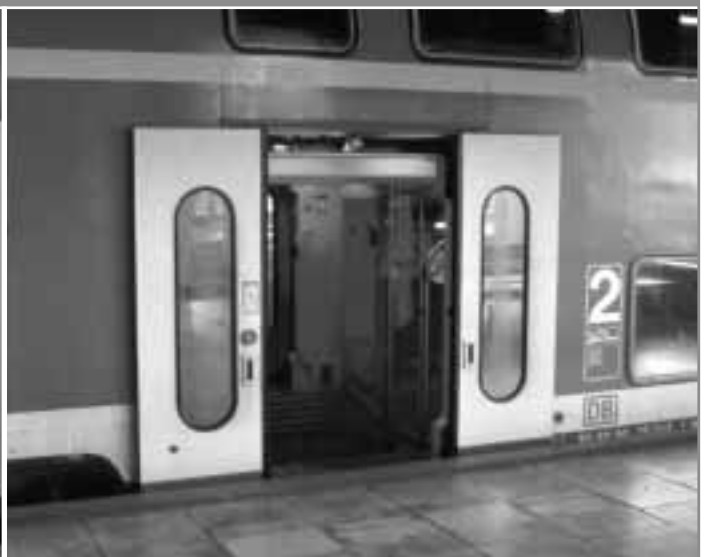
Hochflur-Doppelstockwagen sind am 76-cm-Bahnsteig genauso wenig barrierefrei erreichbar wie die zugehörigen Niederflur-Steuerwagen: Frankfurt (Main) Hbf.
