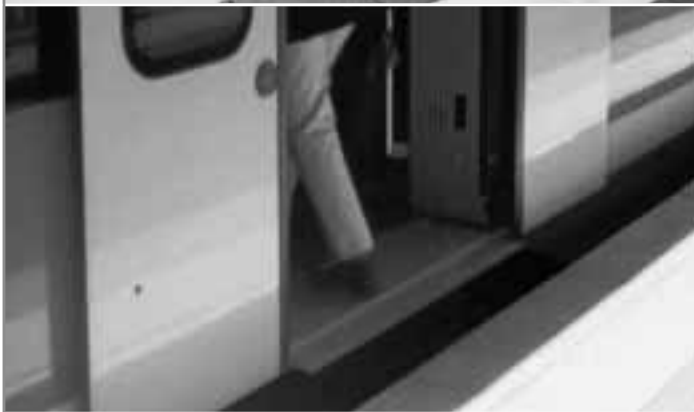
Foto oben: Fast ideale Verhältnisse: gerades Gleis, gleich hoher Bahnsteig, kleiner Spalt.
