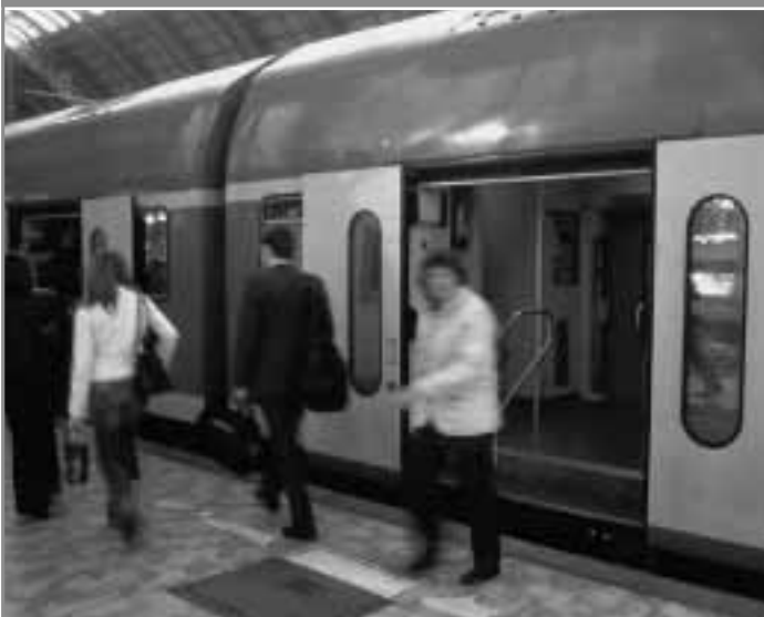
Hochflur-Doppelstockwagen sind am 76-cm-Bahnsteig genauso wenig barrierefrei erreichbar wie die zugehörigen Niederflur-Steuerwagen: Frankfurt (Main) Hbf.
