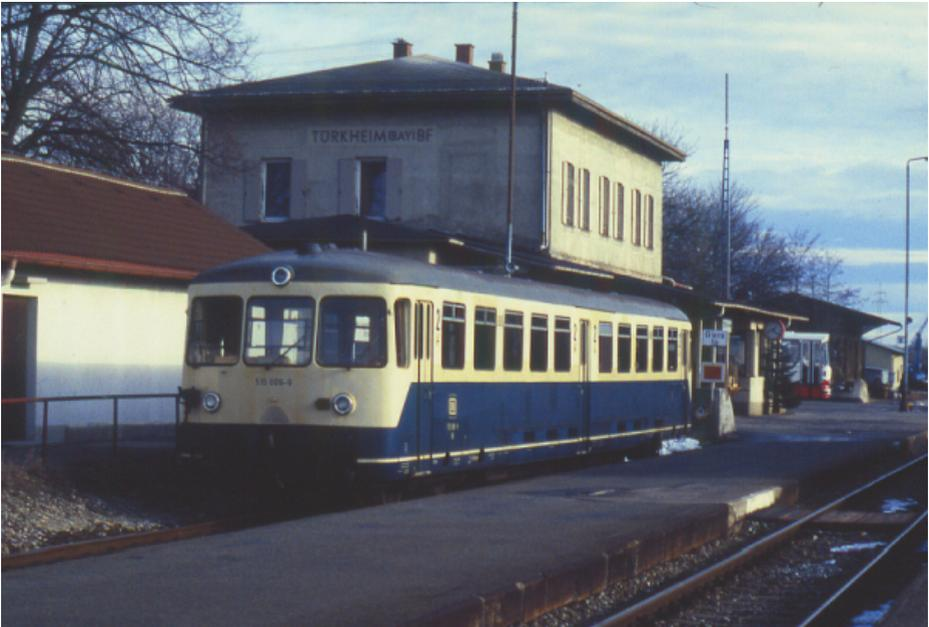
Bereits vor über 30 Jahren befuhren die Akkutriebwagen der Baureihe 515 die nichtelektrifizierten Strecken im Allgäu, hier im Dezember 1986 in Türkheim. Wären moderne Akkutriebwagen eine Alternative zur Elektrifizierung von Bahnlagen? Bild: Matthias Wiegner
