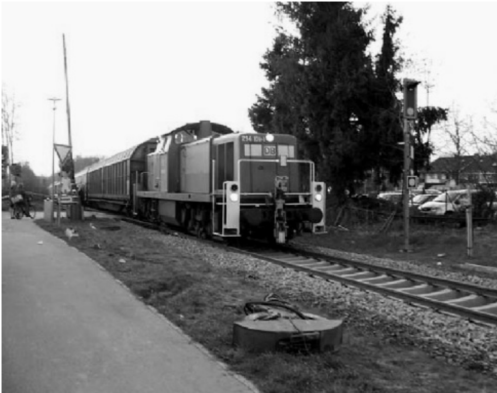
Mit Schrittgeschwindigkeit befährt der erste Zug die renovierte Strecke nach Traunreut. Noch fehlt zwischen den Schwellen der Schotter Foto: A.Locht
