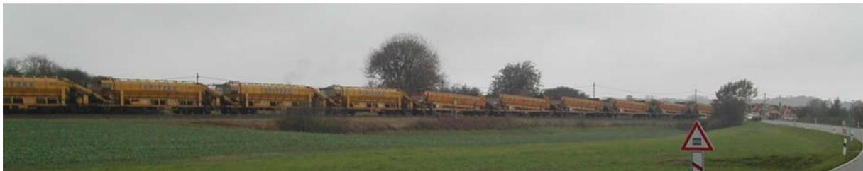
**Gleisschotterreinigungszug bei Blaufelden**
