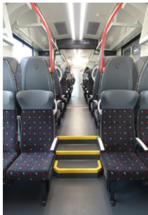
Mehrere kleinere Stufen sind angenehmer zu bewältigen als wenige größere Stufen.
