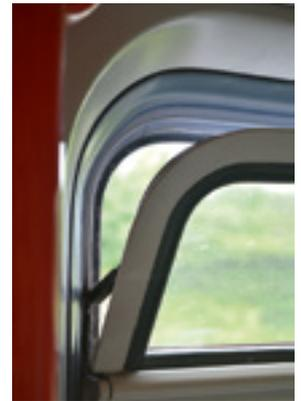
Für den Fall einer ausfallenden Klimatisierung sorgen zu öffnende Klappfenster zumindest für ein wenig Luftwechsel im Fahrgastbereich.
