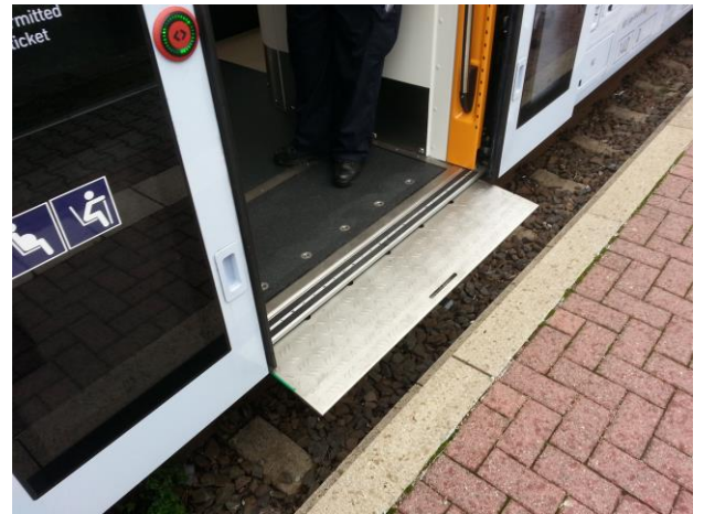
Spalt zwischen Zug und Bahnsteig in Fürth. In Zotzenbach ist dieser Spalt weitaus breiter als hier dargestellt. Ein Mangel der sicherlich technisch lösbar ist...
