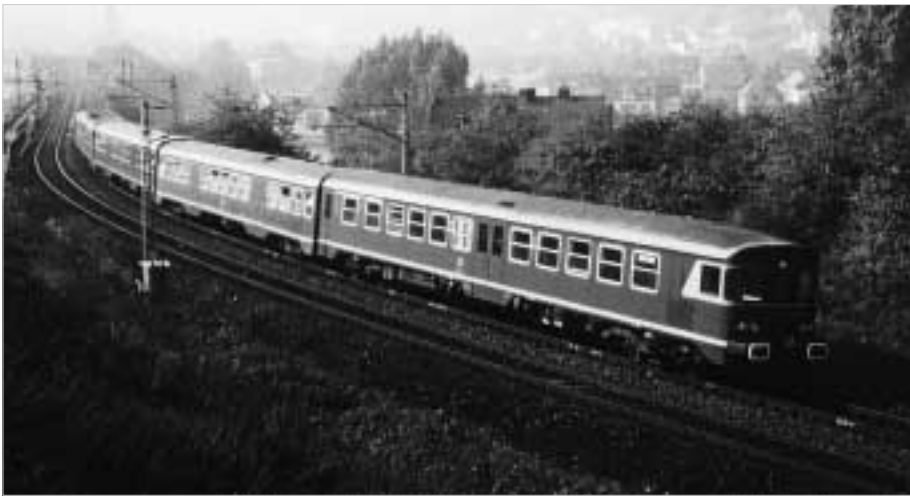
Hier wurde mit diesen Triebwagen Anfang der 70er Jahre die Neigetechnik erprobt: Triebwagen Baureihe 634 auf der Moselstrecke bei Güls.
