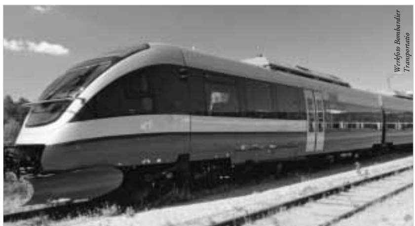
Neigetechnik aus deutscher Produktion: BM 93 aus der „Talent“-Serie von Bombardier für den Einsatz in Norwegen. Es ist der erste Neigezug in Niederflurtechnik.
