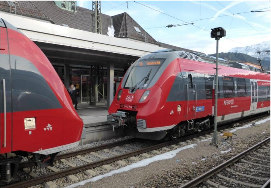
Kuppeln zweier ET 442 in Garmisch-Partenkirchen. Störungen beim Kuppeln und Trennen der Züge sind einer der Gründe für die massiven Verspätungen im Werdenfelsnetz nach der Betriebsaufnahme des „Werdenfelstakts neu“.
