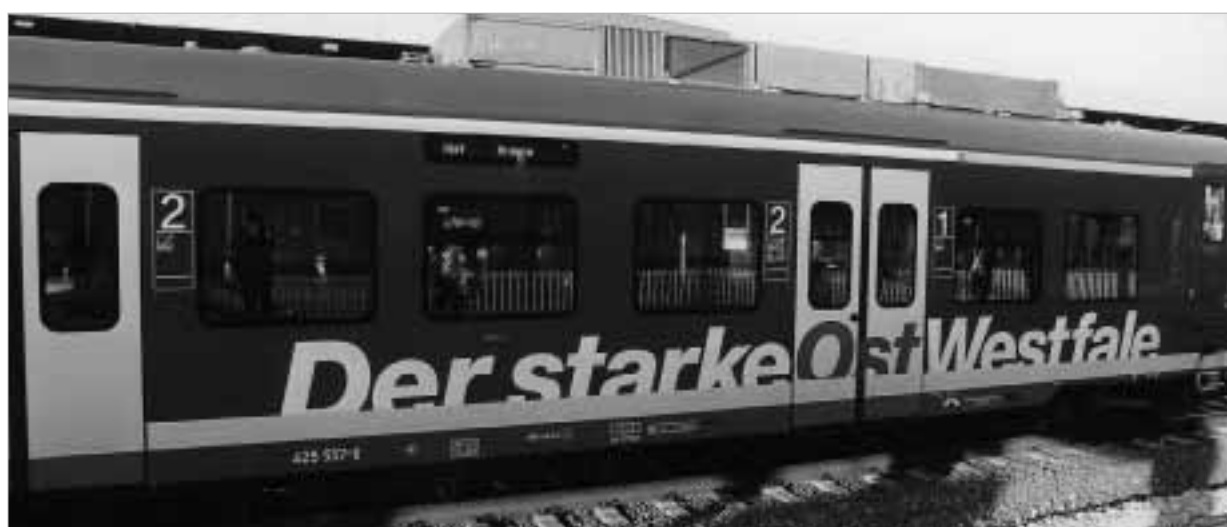
Es geht doch: ein durchgehender Niederflur-Wagenboden und 160 km/h. Doch der ET 425 hat die spartanische Bequemlichkeit der S-Bahn.
