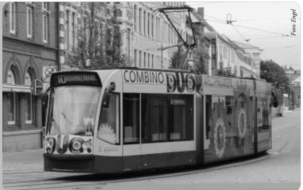
Combino Duo in Nordhausen: elektrisch durch die Stadt, mit Diesel über Land. So kann der günstigere elektrische Antrieb aus dem Dieselmotor gespeist werden, wo der Fahrdrat fehlt.
